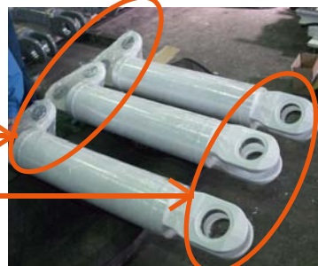
腕部材製作会社にてトグル腕部材として完成
