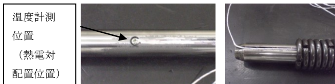
写真3-1 熱電対配置状況
