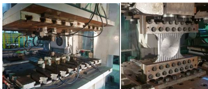
写真 1 試験機へのレンズ型せん断パネル取付け
