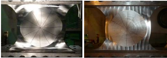
(a) LY100 材 (T=24mm) (b) LY225 材 (T=21mm)
