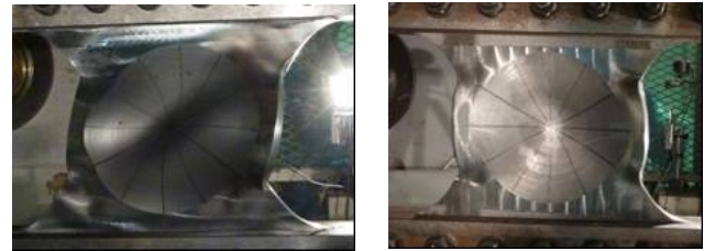
(a) LY100 材 (T=24mm) (b) LY225 材 (T=21mm)
