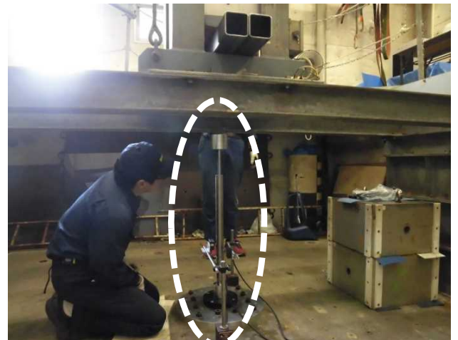
試験状況(リング摩擦ダンパー設置:白破線内)
