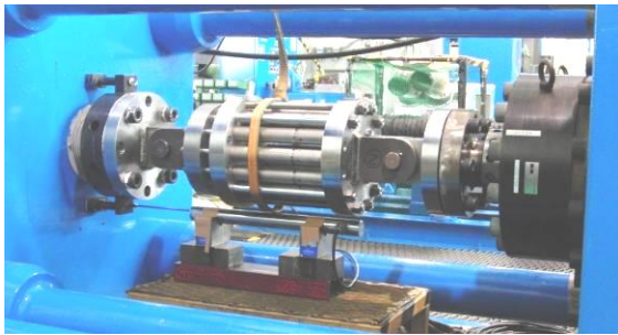
写真4 複合ダンパー外観および試験状況
