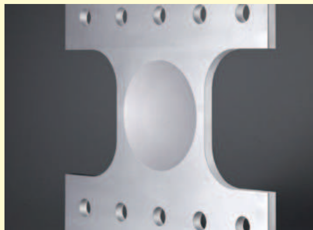
レンズ型パネル中心部の凹レンズ形状（実物写真）
