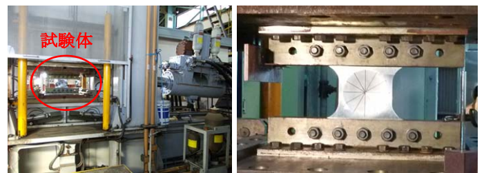
写真1 試験機へのレンズ型せん断パネル取付け
